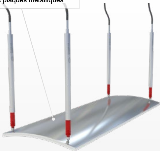
Inspection du fléchissement des plaques métalliques
